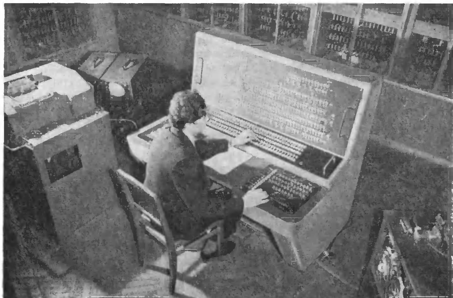
Электронная вычислительная машина БЭСМ-2 Вычислительного центра Академии наук СССР. Машина работает со скоростью, превышающей 8 тыс. математических операций в секунду
