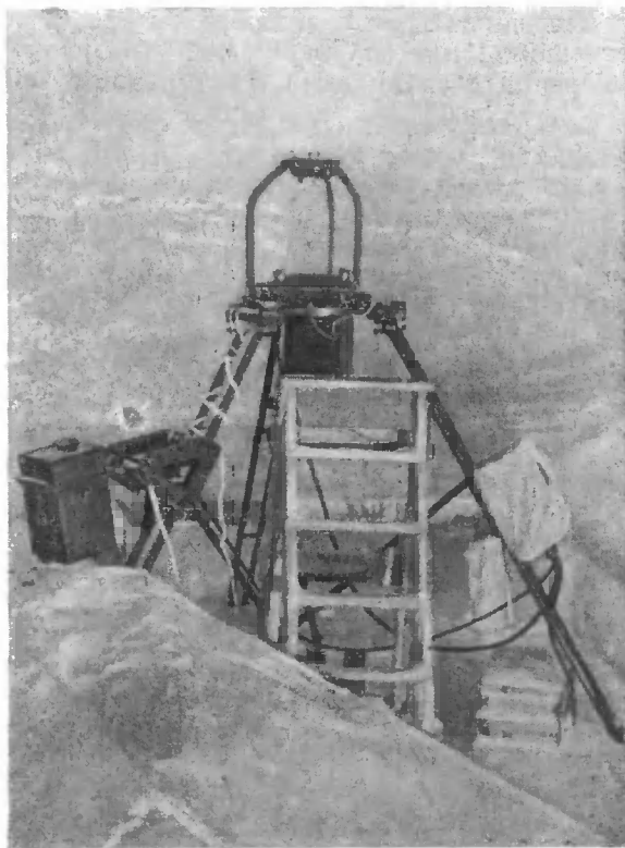
Общий вид камеры С-180 применяемой для изучения полярных сияний. Остров Визе
